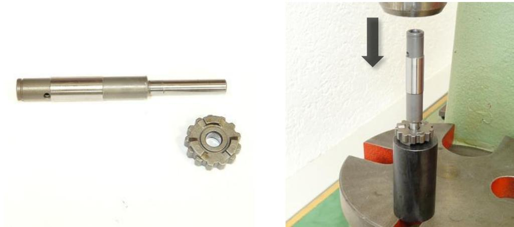
1. Montar a presión el anillo de levas sobre el portaherramientas.
