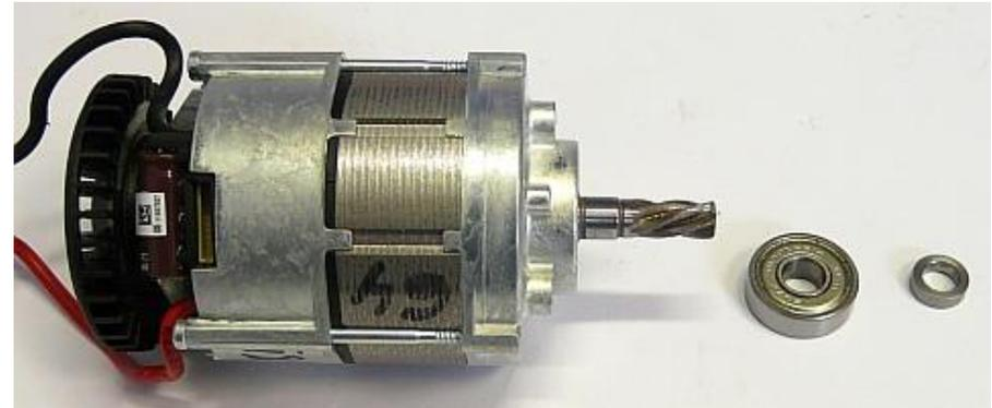
1. Sacar del motor el cojinete de bolas y la junta toroidal.
