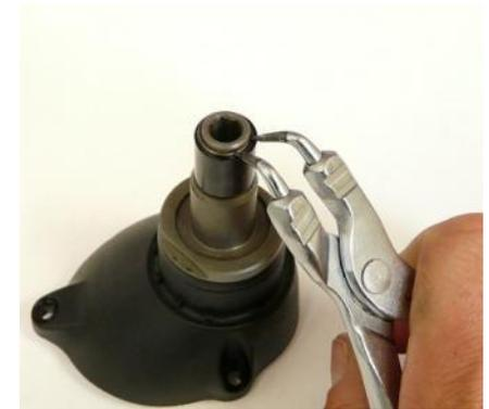
1. Colocar la bola (para la fijación de la broca de la atornilladora) con un poco de grasa en el agujero del portaherramientas.
