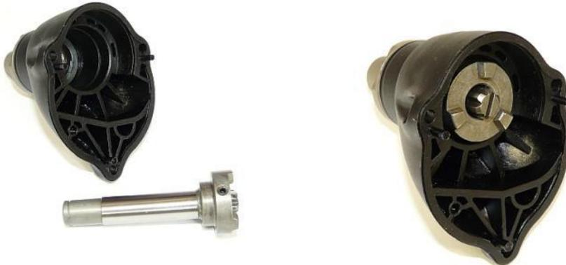
1. Engrasar el portaherramientas e introducirlo en la caja de engranajes.
