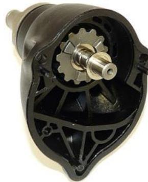
1. Introducir el anillo de levas, el disco, el resorte y el segundo disco en el portaherramientas.
