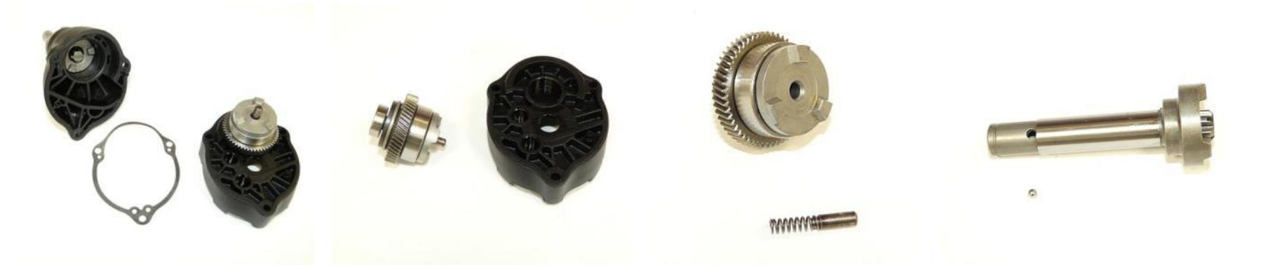
1. Extraer la junta toroidal.
