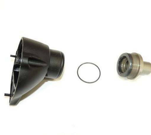
1. Desatornillar el manguito del cojinete del cabezal de engranaje.
