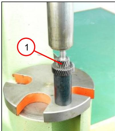
1. Pousser l'arbre de la roue cylindrique (1) dans la roue dentée.
