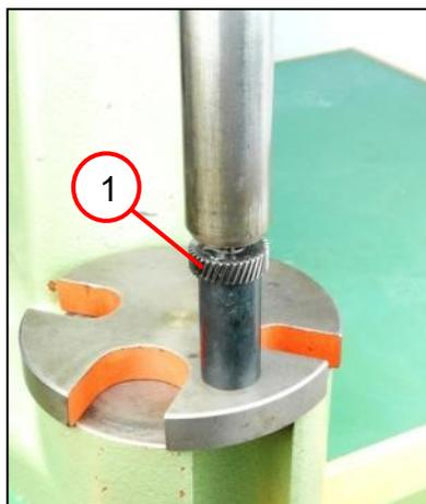
1. Pousser la roue dentée (1) hors de l'arbre de la roue cylindrique.
