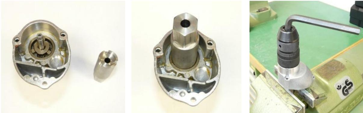
1. Desatornillar el cabezal de engranaje.
