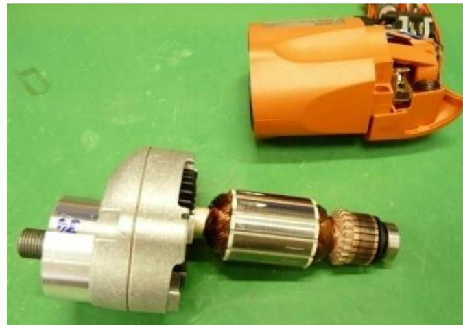
1. Desatornillar los tornillos de la caja de engranajes
