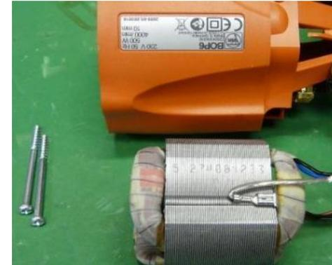
1. Desatornillar los contactos enchufables del campo magnético en el interruptor
