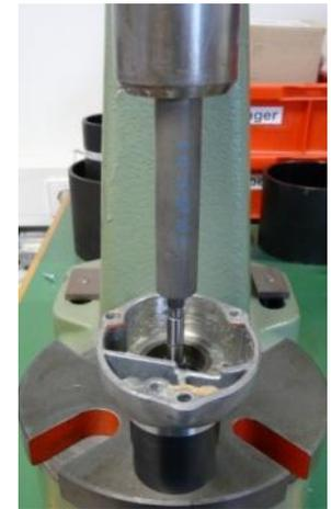
1. Cogner légèrement sur le boîtier d'engrenage pour enlever la roue dentée -
