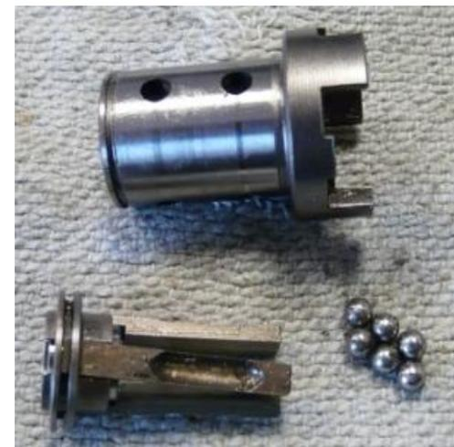
1. Enlever les roues dentées de la douille d'entraînement – **Attention 6 billes se trouvent sous les roues dentées !!!**
