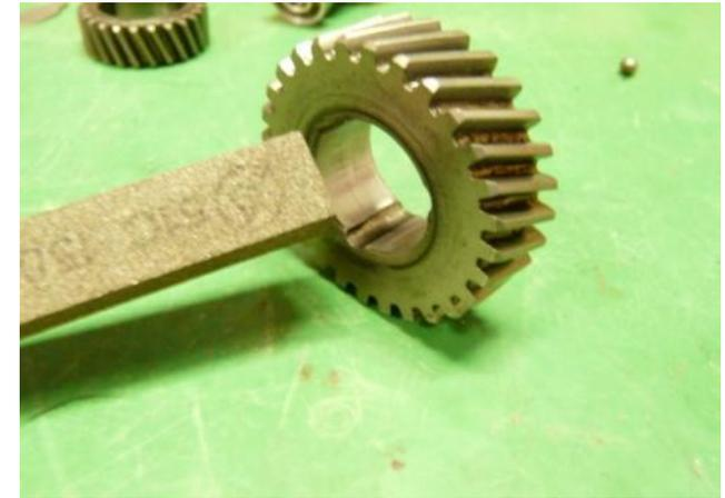
1. Retirer les roues dentées – Attention Sous les roues dentées se trouvent des billes indispensables pour l'entraînement des roues dentées, ne pas les perdre
