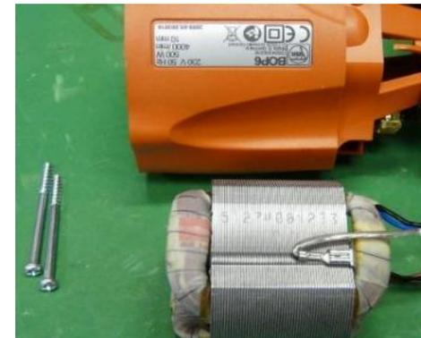
1. Desserrer les contacts à fiche du stator sur l'interrupteur
