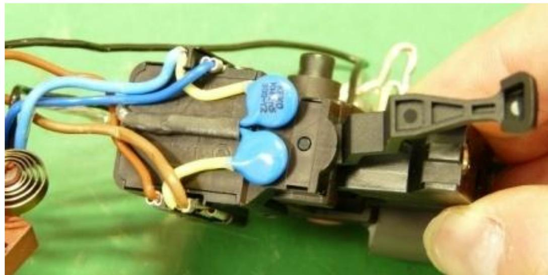
**Attention** – lors du montage de la machine le câblage doit être exact (voir les photos), sinon il y a risque coincement des câbles dû à l'espace très réduit, ce qui peut entraîner un dysfonctionnement de la machine.
