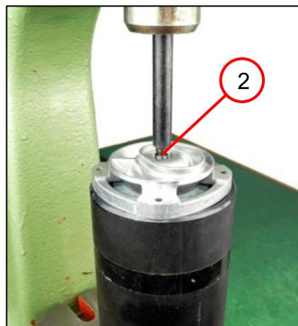
1. Girar hacia abajo el semi-acoplamiento (1).
