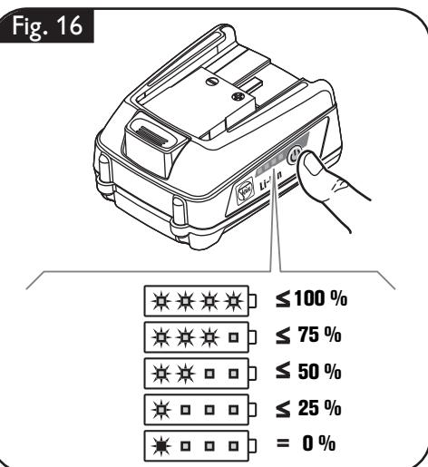
El porcentaje del estado de carga real del acumulador solamente se indica estando detenido el motor de la herramienta eléctrica.
