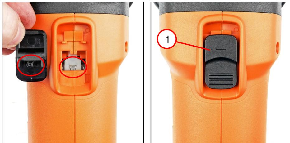
1. Mettre en place l'interrupteur (1).
