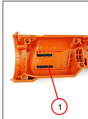
1. Alle Bauteile aus der Gehäusehälfte herausnehmen.
