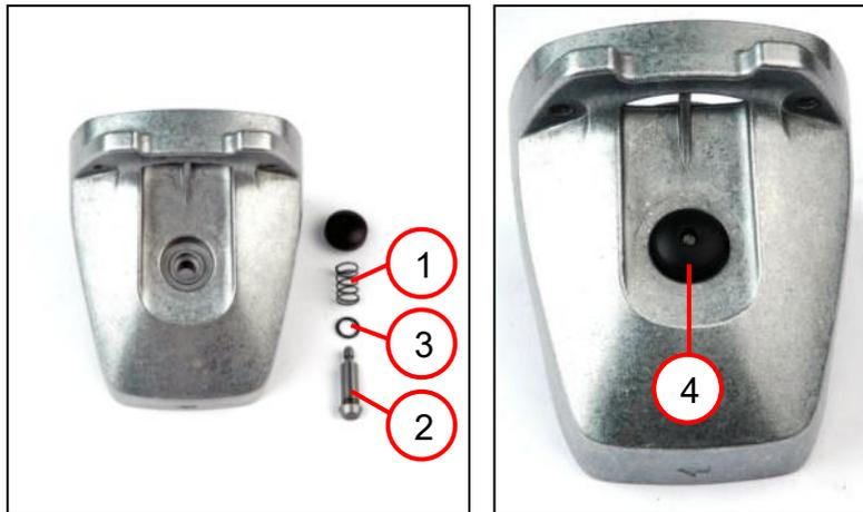
1. Die Spiralfeder (1) und den Bolzen (2) mit Dichtring (3) einsetzen.
