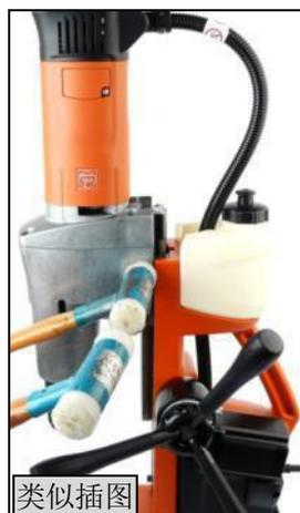
1. 用力敲击导向装置（1），使导向板之间没有间隙。
