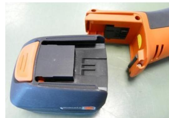
1. Нажмите кнопку разблокировки и снимите аккумулятор.
