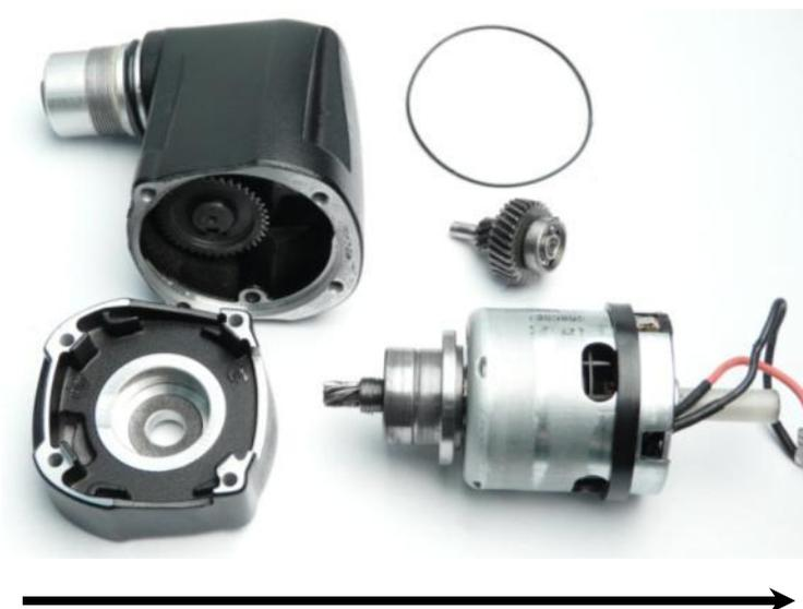
1. Снимите промежуточный подшипник с редуктора.
