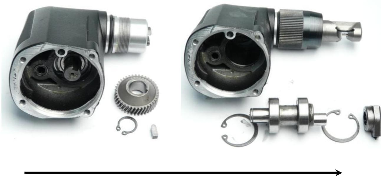
1. Снимите стопорное кольцо, извлеките зубчатое колесо и призматическую шпонку.
