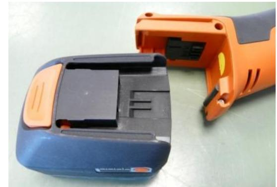
1. Presser le bouton de déverrouillage et retirer la batterie.
