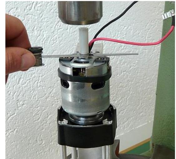
1. Insérer la bague de tolérance dans le coussinet.
