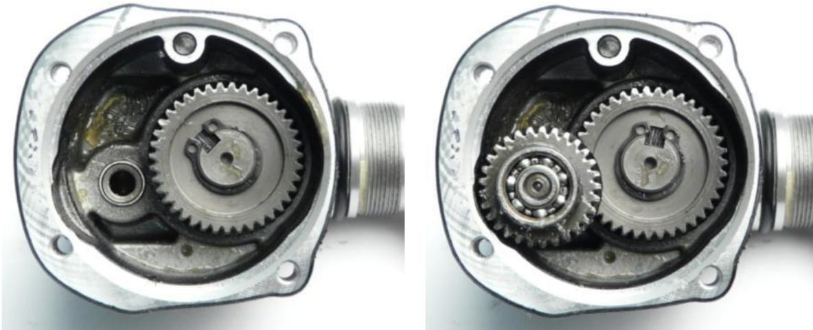
1. Monter la clavette et la roue dentée sur l'arbre d'excentrique, puis monter le circlips.
