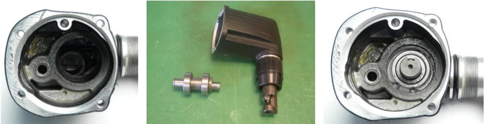
1. Introduire l'entraîneur avec la douille à aiguilles dans le poussoir.
