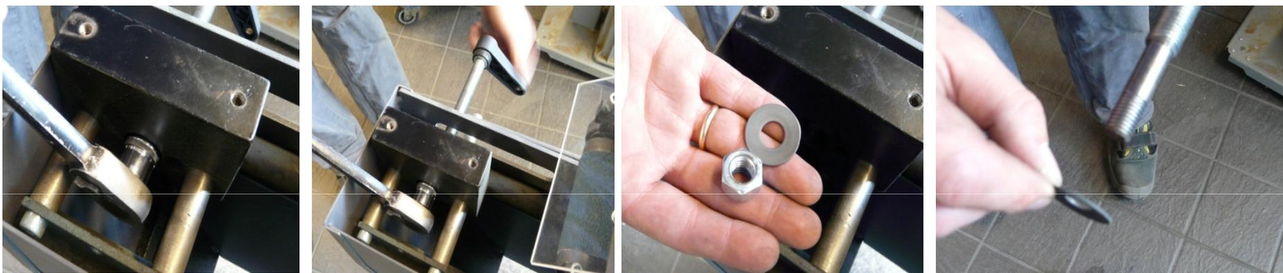
1. Desatornillar completamente el husillo roscado para desplazamiento lateral
