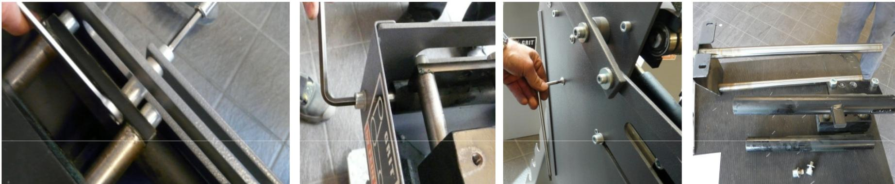
1. Desatornillar el tornillo para la fijación de la palanca
