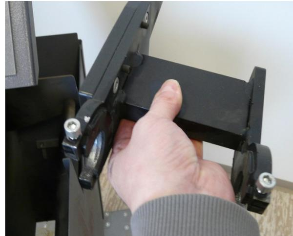
1. Desatornillar el tornillo Allen para el ajuste de altura
