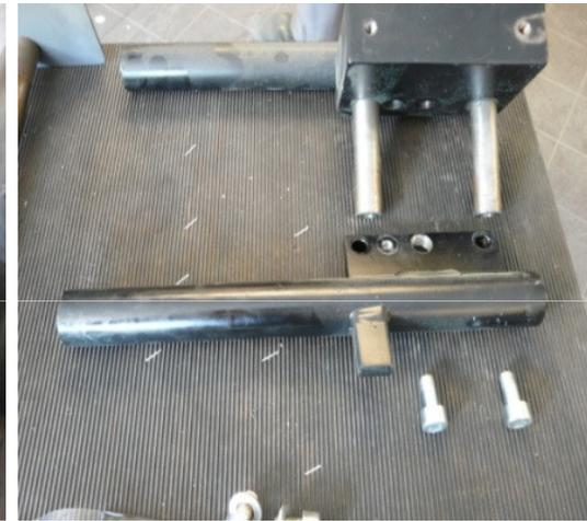
1. Desatornillar los dos tornillos de fijación para el desplazamiento lateral
