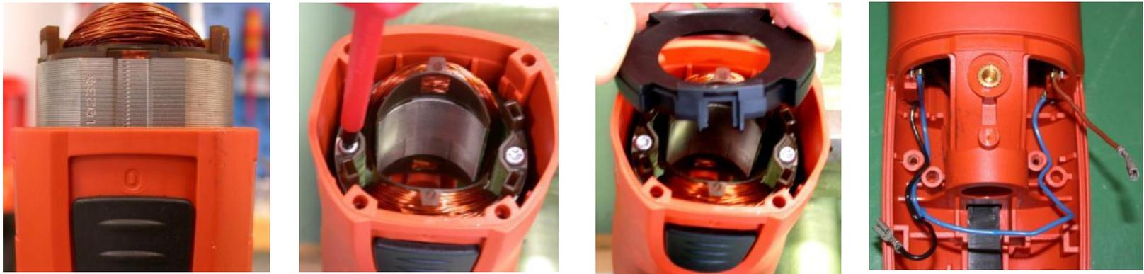
1. Disposer l'inducteur **(40)** dans le boîtier du moteur **(10)** avec l'inscription du côté de l'interrupteur.
