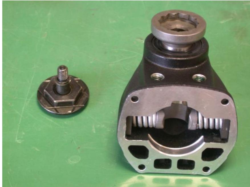
**La tête de transmission des FSC 1.6 X et FSC 2.0 X est disponible pour la rechange sous forme d'organe complet (405) afin de maintenir le coût des outils spéciaux et les temps de réparation le plus bas possible.
