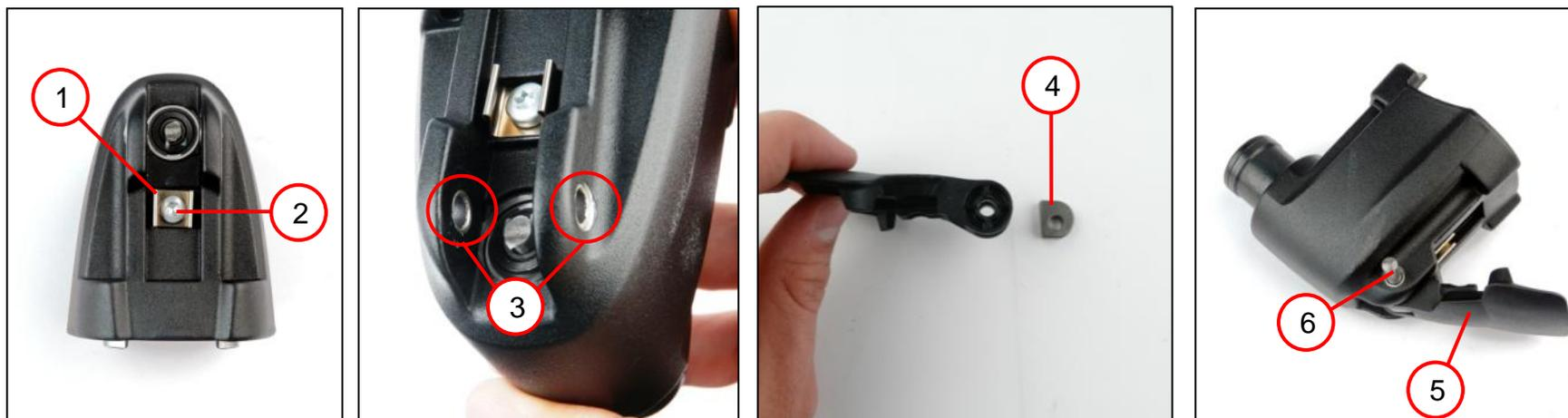
1. Fixer le ressort de retenue (1) avec la vis à tête fraisée bombée (2) [2,0 ±0,1 Nm].
