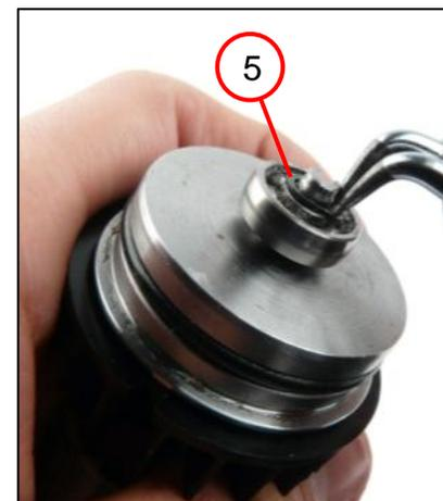
1. Exercer une pression sur le roulement à billes rainuré (1).
