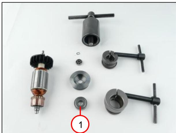
1. Retirer le roulement à billes (1) du rotor.
