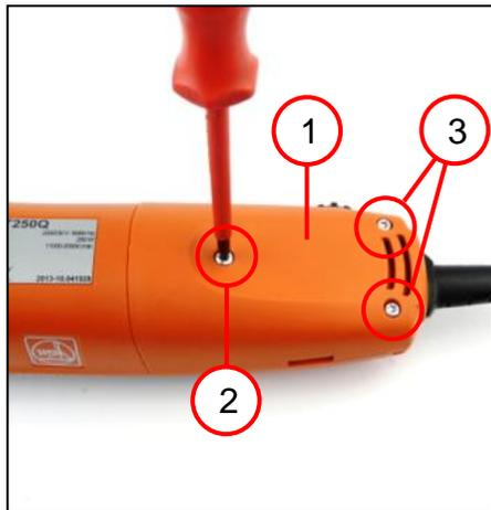
1. Den Deckel (1) auf das Motorgehäuse setzen.
