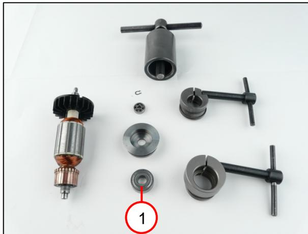
1. Das Kugellager (1) vom Anker abziehen.
