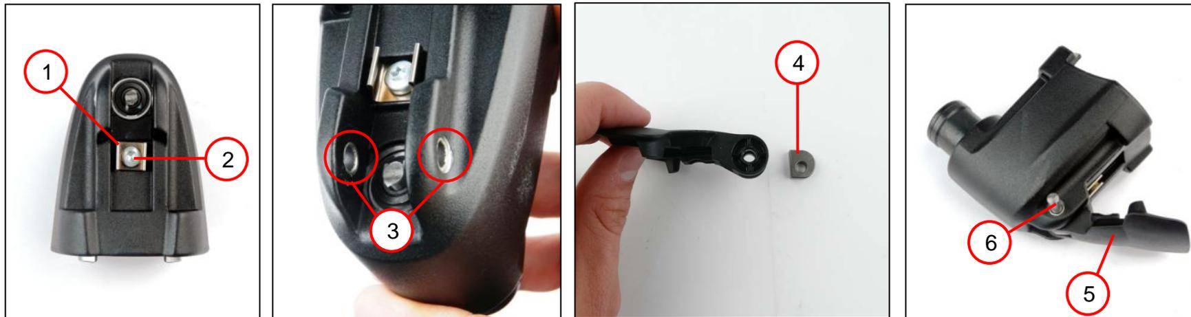
1. Die Haltefeder (1) mit der Linsenschraube (2) befestigen [2,0 ±0,1Nm].
