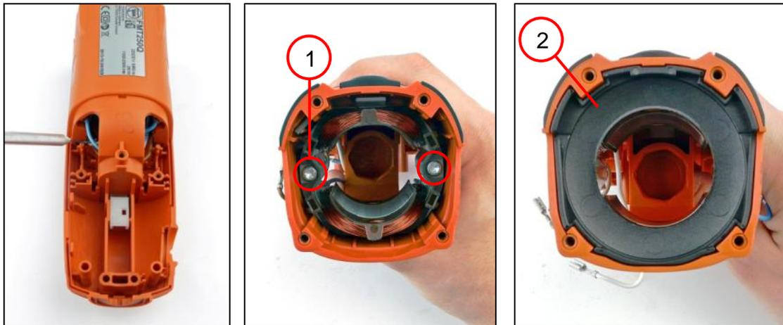
1. Die Kabel mit dem Haken aus dem Stator herausziehen.
