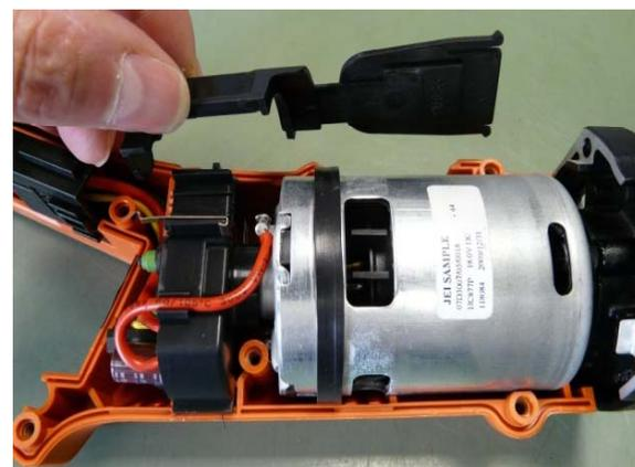
Introducir el motor con el sistema electrónico y el cojinete intermedio en la parte inferior de la carcasa.
