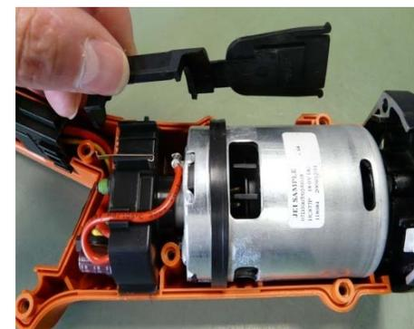
Soltar los tornillos de la carcasa de motor.
