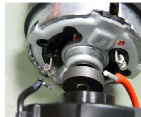
Sacar el motor con el sistema electrónico y el cojinete intermedio de la parte inferior de la carcasa.
