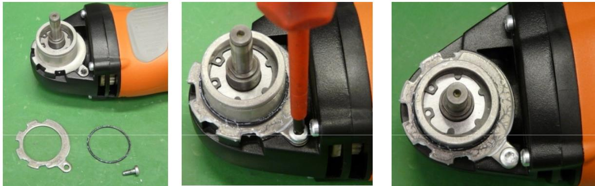
1. Colocar el disco y la junta tórica en la caja de engranajes y fijarlos con el tornillo
