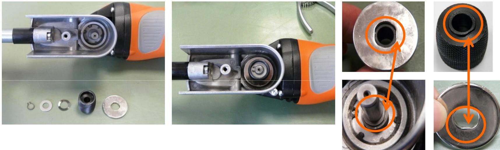
1. Colocar el disco distanciador, la rueda de accionamiento con arandela elástica y la arandela en el husillo
