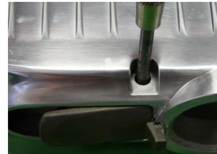
1. Colocar el perno de guía y asegurarlo con el tornillo (Dispositivo de retención de tornillos – Loctite 242 azul)
