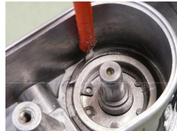
1. Depositar el cuello de lijado premontado en la caja de engranajes –
