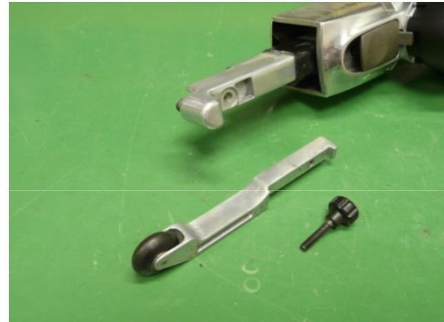
1. Desatornillar el tornillo de ajuste.
