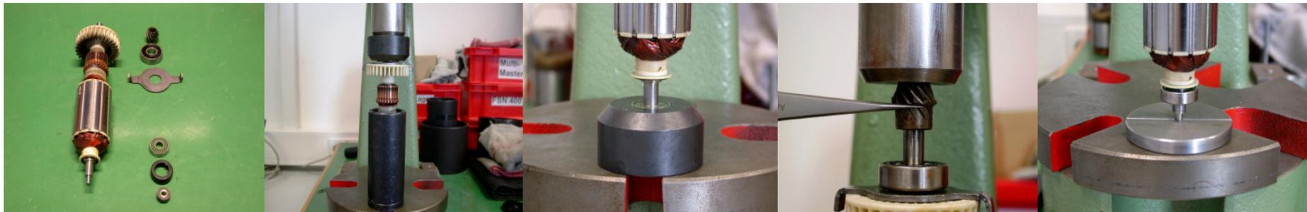
1. Anker in Aufpressvorrichtung einsetzen.
