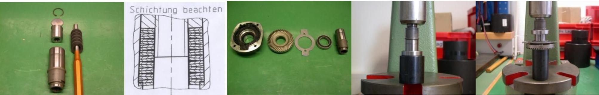
1. Disposer le jeu de ressorts, l'élément de pression et la plaque de compression sur l'arbre de transmission
