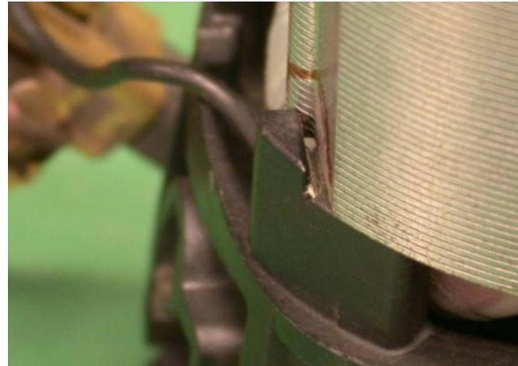
La cause du frottement du rotor : mauvais positionnement du stator. Un contrôle visuel permet de le vérifier rapidement.
