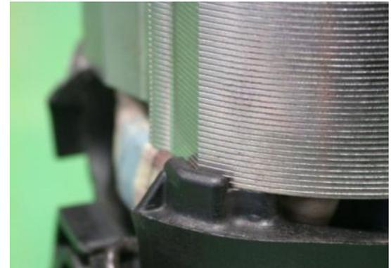
Un stator positionné correctement ne présente aucun jeu au niveau des ergots de positionnement.
