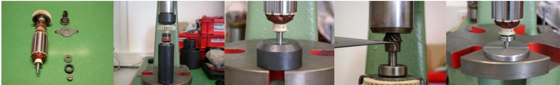
1. Disposer l'induit sur le dispositif d'emmanchement.
