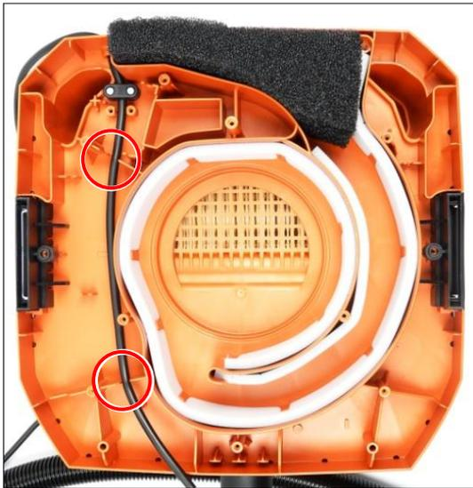
4. Das Kabel in der Führung platzieren.
