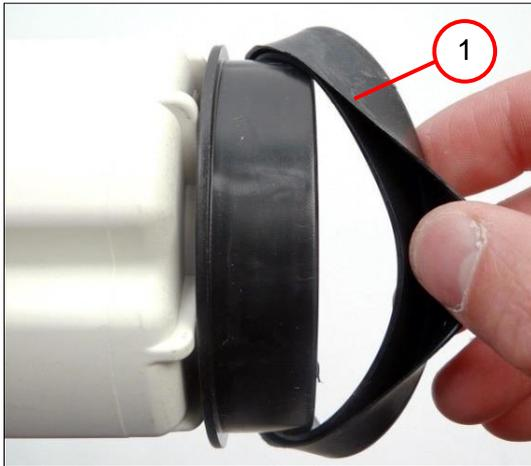
5. Die Dichtung (1) entfernen.
