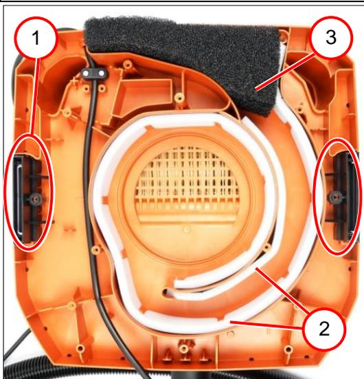
1. Die zwei Laschen mit Druckstück (1) entfernen.
