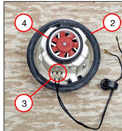
2. Das Kabel zweimal durch den Ferritkern(1) wickeln.
