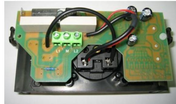
1. Netzkabel (blau/braun) und Schutzleiter abschließen, Motorzuleitung (schwarz) abschließen und Steckkontakt an der Elektronik lösen.
