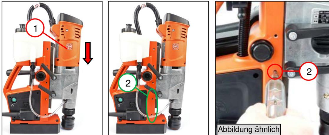
1. Den Bohrmotor (1) in die untere Position fahren.
