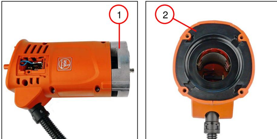
1. Das Zwischenlager (1) entfernen.
