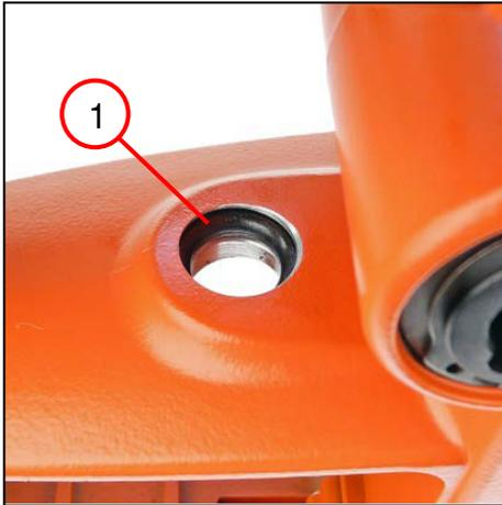
1. Den Dichtring (1) entfernen.
