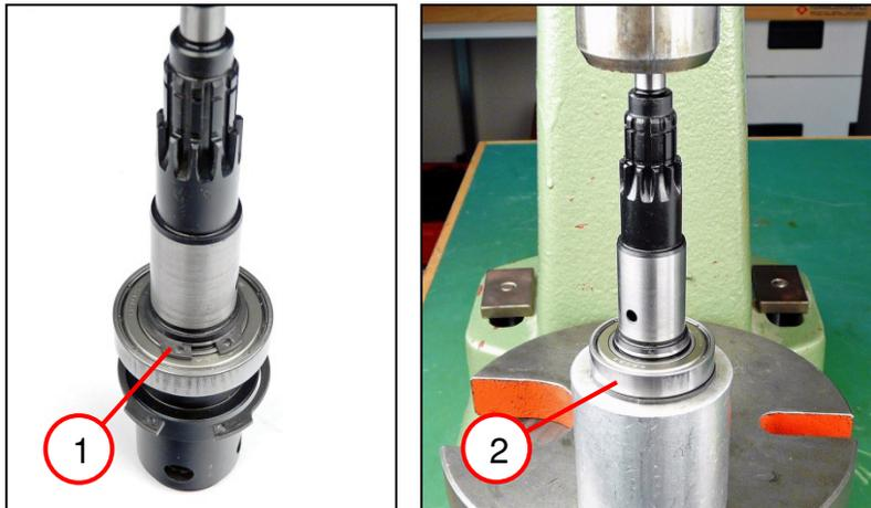
1. Den Sicherungsring (1) entfernen.
