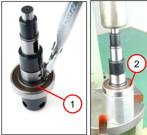
1. Den Sicherungsring (1) entfernen.
