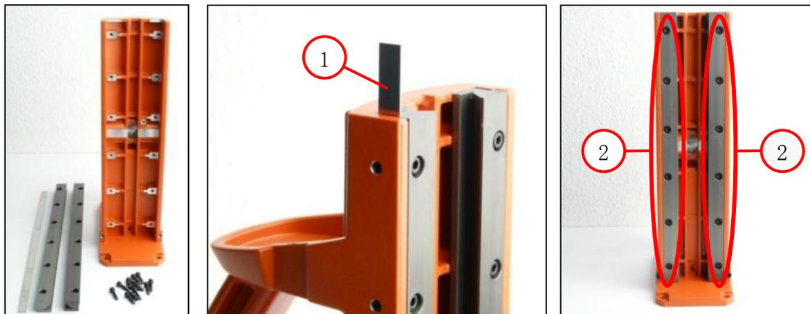
1. 将推力块 (1) 推到导轨后方。
