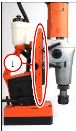
1. 借助六颗销栓 (1) 调节导向装置的间隙。
