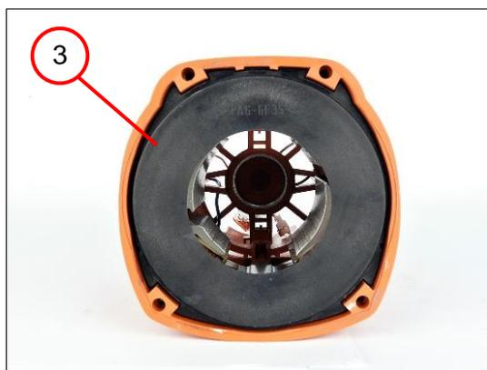
3. Colocar el anillo conductor de aire (3).
