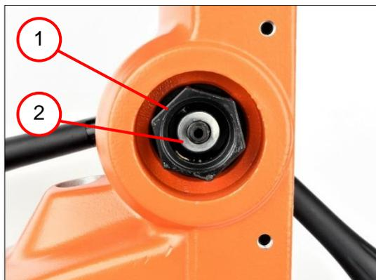
1. Colocar el semi-acoplamiento (1).
