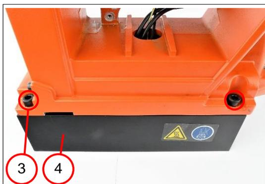
3. Desenroscar los dos tornillos cilíndricos [M8x22] (3).
