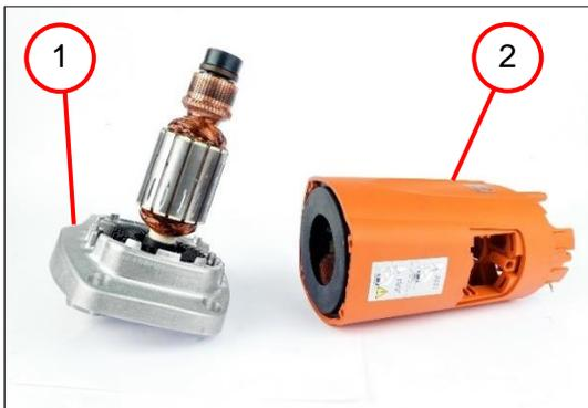
1. Colocar el cojinete intermedio (1) en la carcasa de motor (2).
