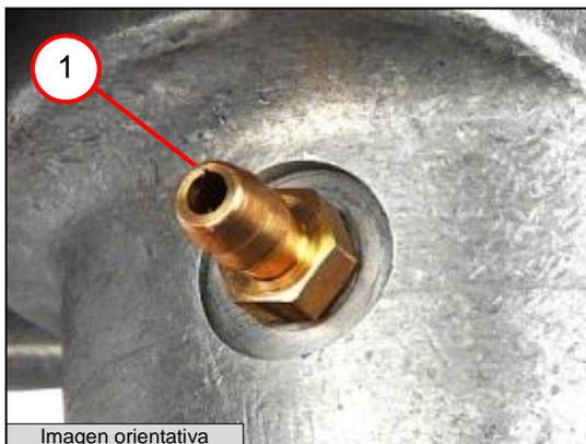
2. Desenroscar la boquilla para conexión de mangueras (2).
