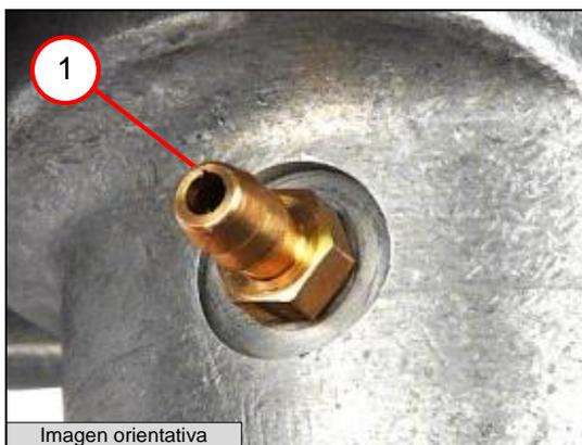
3. Montar la boquilla para conexión de mangueras (1) [1,8 Nm  $\pm$ 0,25 Nm].
