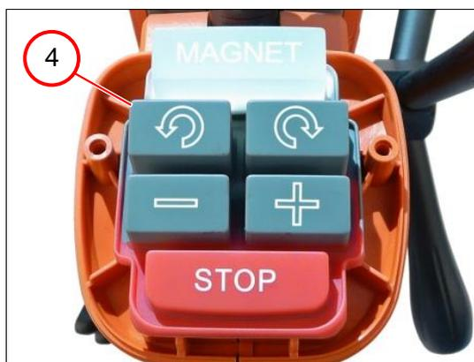
4. Colocar la pieza insertada de interruptor (4).
