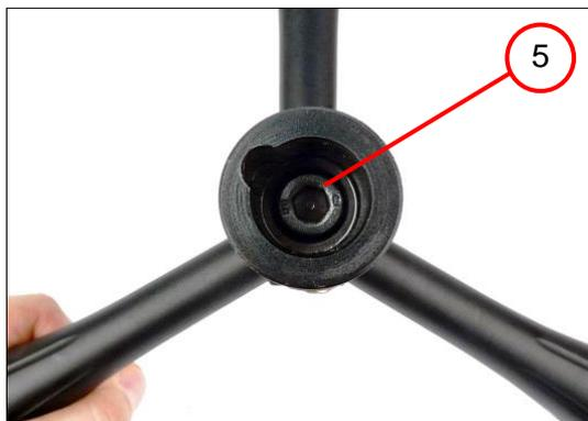
6. Apretar el tornillo cilíndrico (5) [8,0 Nm  $\pm 0,5$  Nm].
