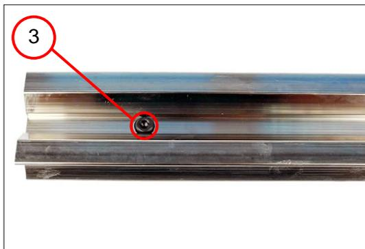
11. Enroscar el tornillo (3) [ $3,0 \text{ Nm} \pm 0,3 \text{ Nm}$ ].
