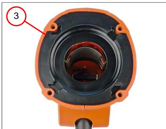
3. Colocar el anillo conductor de aire (3).
