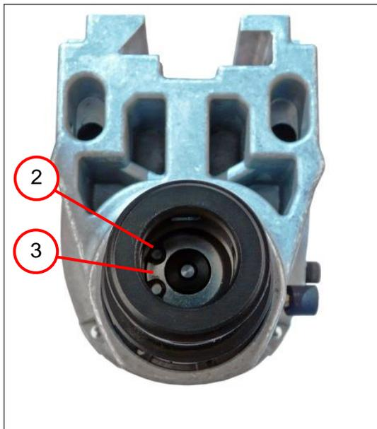
7. Desmontar el anillo de retención (2).
