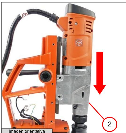
2. Insertar el motor de perforación (2) en la guía.
