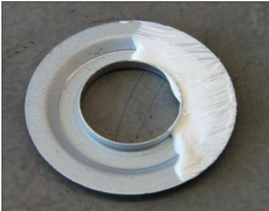
5. Lubricar la junta toroidal con grasa.
