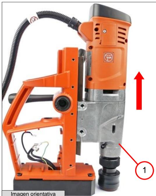
4. Sacar el motor de perforación (1) de la guía.
