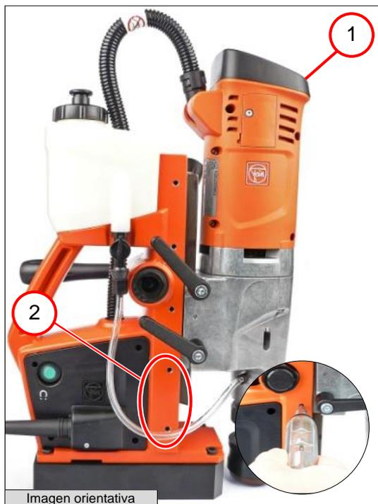
4. Desplazar el motor de perforación (1) a la posición superior.
