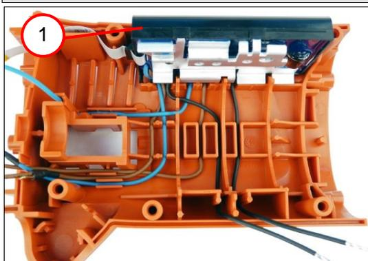
1. Retire el sistema electrónico (1).
