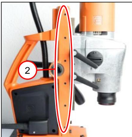
1. С помощью шести установочных штифтов (2) добейтесь отсутствия зазора направляющей.
