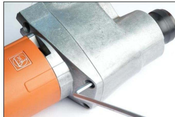
1. Заправьте 120 г смазки в корпус редуктора.
