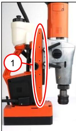
1. Régler le jeu du guidage à l'aide des six vis filetées (1).
