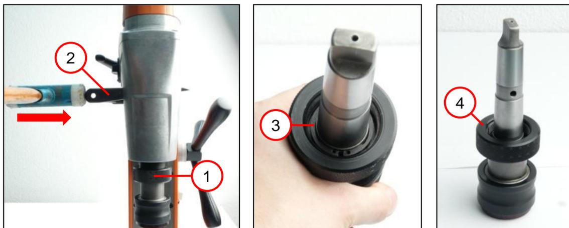
1. Desserrer l'écrou (1) [filetage à gauche].
