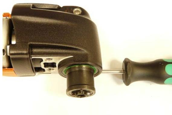
1. 拧紧齿轮箱下部的两个螺丝，固定住齿轮箱。
