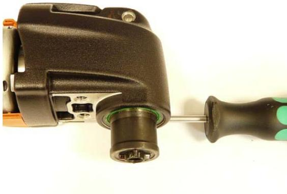
1. Visser le carter d'engrenage avec deux vis dans la partie inférieure du carter.
