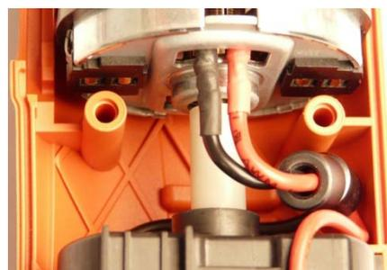
Nouveau moteur avec manchon en ferrite et nouveau système électronique avec gobelet
