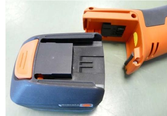
1. Presser le bouton de déverrouillage et retirer la batterie.
