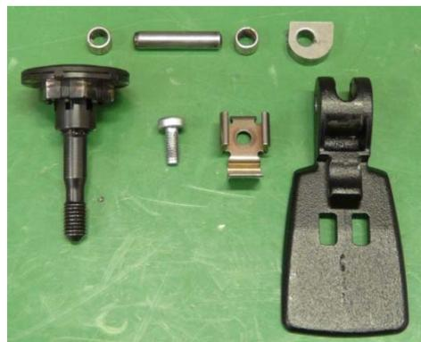
En raison des directives relatives à la force de sertissage de l'arbre d'entraînement qui ne peut être garantie après la réparation, le carter d'engrenage est remplacé ou proposé comme pièce de rechange uniquement sous forme de module complet.
