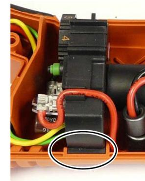
1. Insérer le moteur/l'unité d'entraînement prémonté(e) et le système électronique dans le fond du carter.
