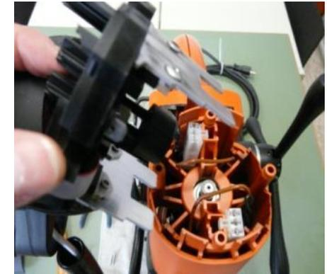
**Insertar las escobillas de carbón y conectarlas**
