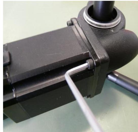
**Montar el motor de avance y el engranaje de avance –
