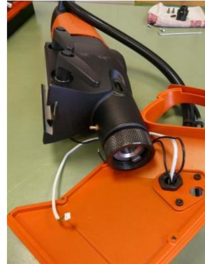
**Retirar la cubierta del sistema electrónico con la bomba de refrigerante y los tubos**
