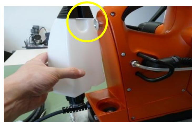
**Levantar el depósito de refrigerante con un destornillador y tirar manualmente hacia arriba hasta que el depósito salga de la retención del extremo superior (círculo amarillo).
