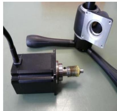
**Soltar los tornillos de la fijación del motor**
