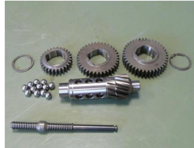
Desmontar el engranaje intermedio grande - las tres ruedas dentadas que conectan las marchas están colocadas por deslizamiento y se retienen o liberan mediante las bolas, dependiendo de la selección de marcha
