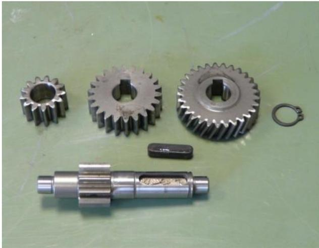
Desmontar el engranaje intermedio pequeño – las 2 ruedas dentadas grandes están colocadas por deslizamiento y se pasan por el muelle de ajuste, la rueda dentada pequeña está montada a presión. En este caso, al desmontar la rueda dentada pequeña también se destruye la unión apretada, con lo que no pueden seguir utilizándose ni la rueda dentada pequeña ni el árbol. El par prescrito ya no se puede transmitir.
