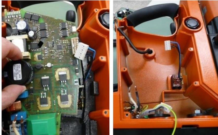
**Después de separar todas las conexiones de la placa a los interruptores y otros elementos constructivos, ya puede extraerse la placa del material celular y/o del bastidor.**
