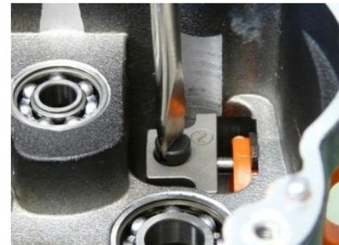
**Insertar la empuñadura de maniobra y fijarla con el anillo de retención
