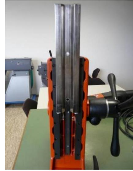
**Colocar las placas de deslizamiento en el soporte y presentar los tornillos (no apretarlos a tope)**
