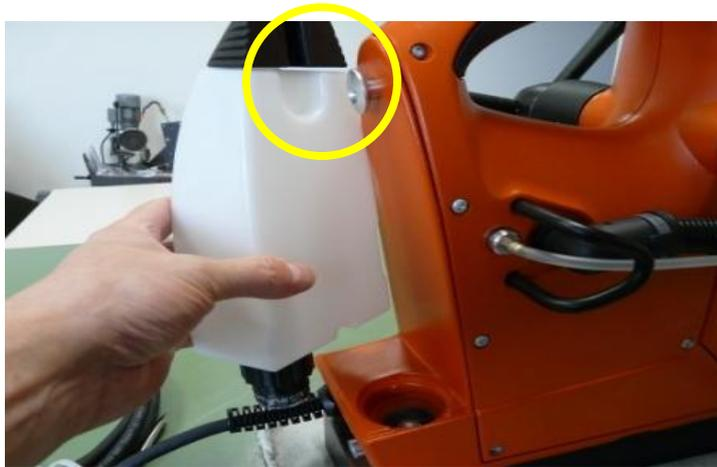
**Colocar el depósito de refrigerante en la guía superior (círculo amarillo) y, a continuación, presionar hacia abajo**
