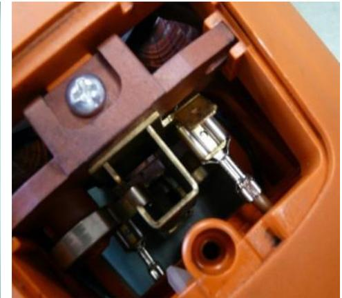
**Insertar el campo magnético en la carcasa de motor, para ello es preciso pasar los cables por la carcasa de motor**
