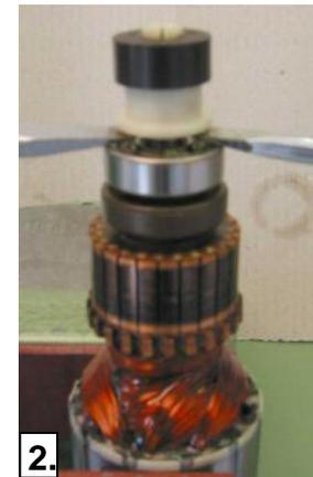
1. Nilosring [\(135\)](#) abnehmen. Rillenkugellager [\(70\)](#) zusammen mit Dichtungsring [\(80\)](#) von Anker [\(40\)](#) mit Abziehwerkzeug abziehen.
