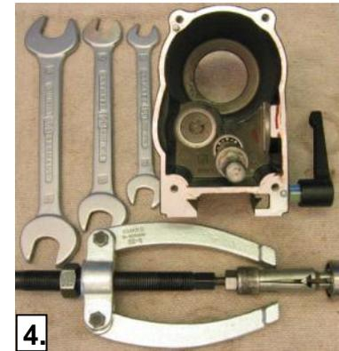
1. Bohrwelle **(320)** nach vorne aus dem äußeren Lager **(300)** treiben.
