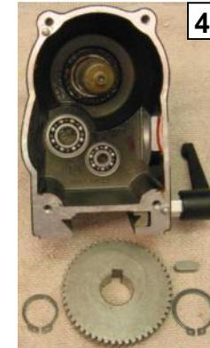
1. Zylinderschraube [\(590\)](#) entfernen und äußeres Lager [\(280\)](#) abnehmen.
