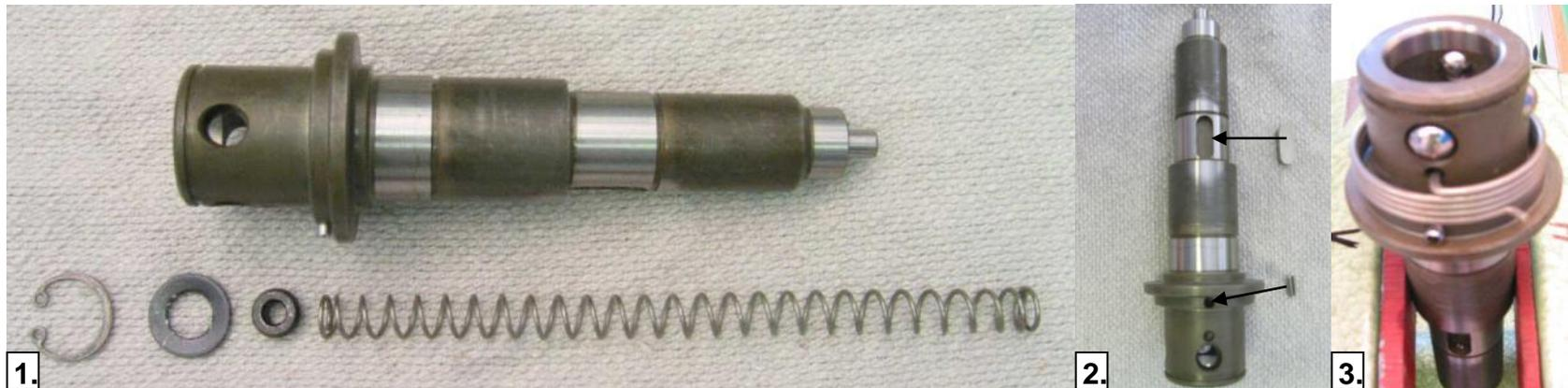
1. Druckfeder (330) , Hülse (340) und Scheibe (350) in Bohrwelle (320) einlegen. Sicherungsring (360) in Bohrwelle einsetzen. Alle Teile zusammen in Bohrwelle (320) mit Bolzen eindrücken, bis der Sicherungsring verriegelt.
