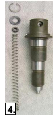
1. Sicherungsring **(410)** entfernen und Spannhülse **(400)** nach vorne abziehen.
