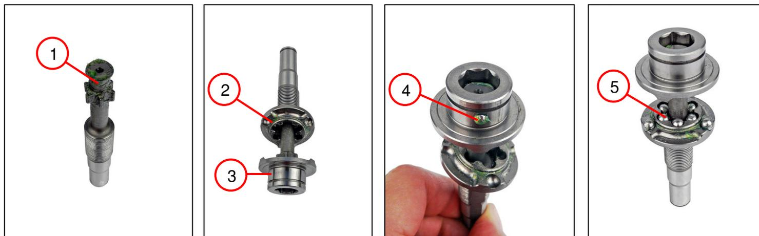
1. Смажьте инструментальный держатель (1) пластичной смазкой.
