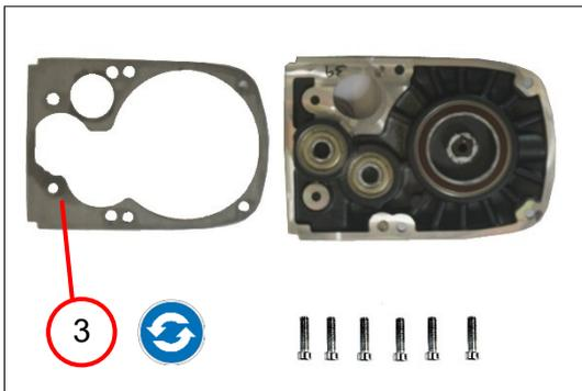
3. Die Dichtung (3) entfernen.
