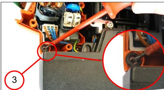
3. Den Dichtring (3) entfernen.
