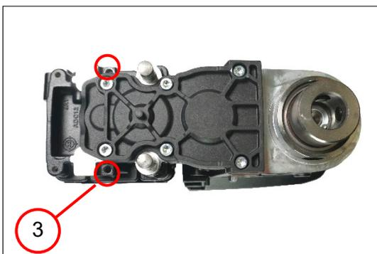
5. Die zwei Schrauben (3) eindrehen [2,4Nm].
