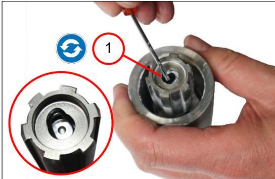
9. Die Dichtung (1) entfernen.
