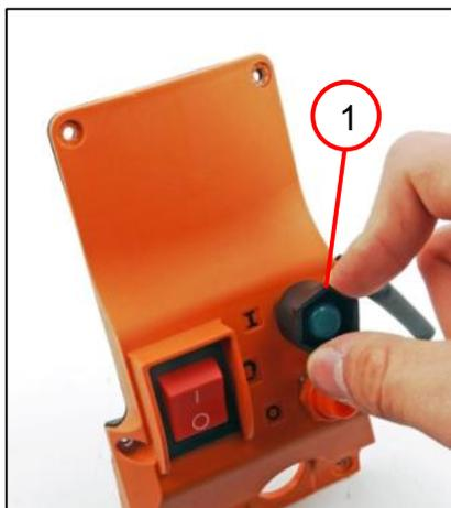
1. 将防护罩（1）拧紧到开关模块上。
