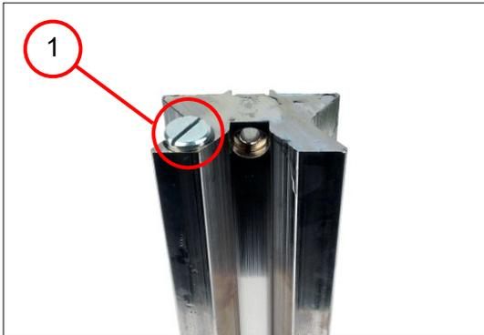
7. Die Flachkopfschraube (1) eindrehen [1,2 Nm  $\pm 0,15$  Nm].
