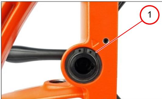
1. Den Sicherungsring (1) entfernen.
