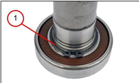
1. Den Sicherungsring (1) entfernen.
