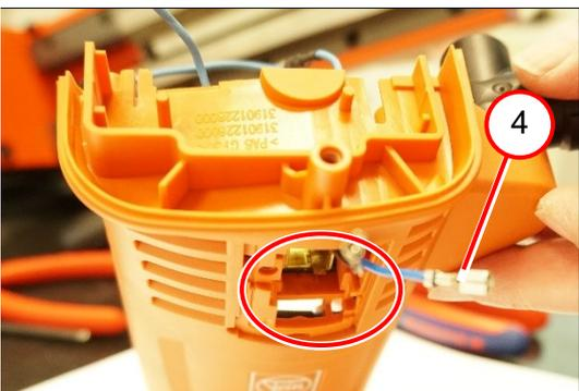
8. Das Kabel (4) durch die Öffnung für die Kohlebürsten führen.
