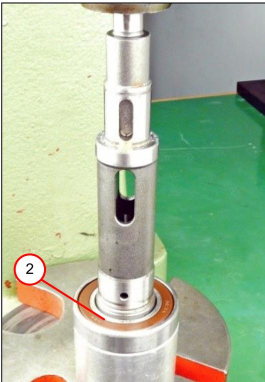
2. Das Rillenkugellager (2) von der Welle pressen.
