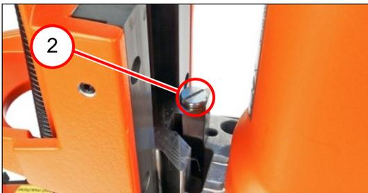
4. Die Schraube (2) eindrehen [2,7 Nm  $\pm 0,3$  Nm].
