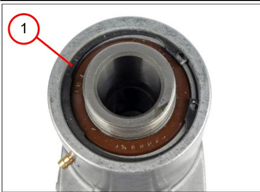
1. Den Sicherungsring (1) entfernen.
