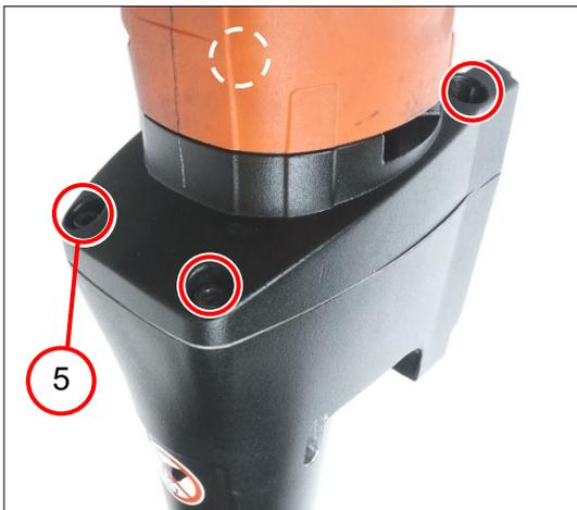
2. Die vier Schrauben (2) eindrehen [8,0 Nm  $\pm$ 0,3 Nm].
