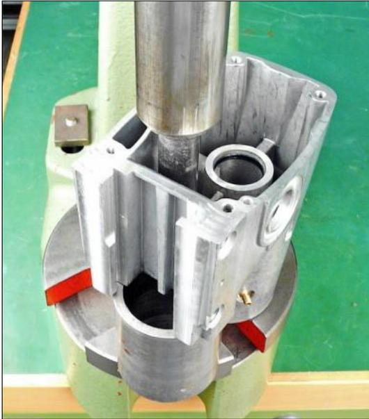
9. Die zwei Rillenkugellager (1) einpressen.
