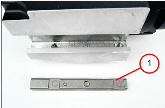
6. Das Druckstück (1) entfernen.
