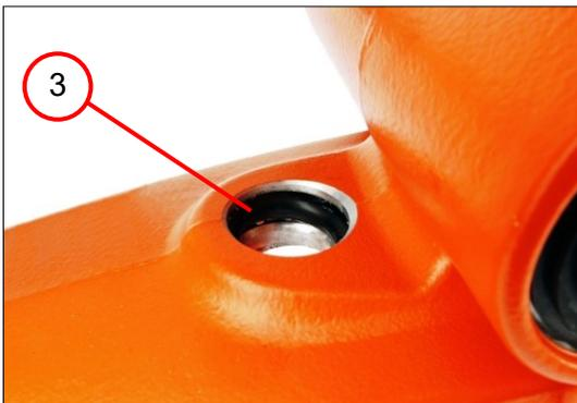
3. Den Dichtring (3) entfernen.
