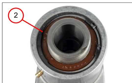
3. Placer le circlip (2).
