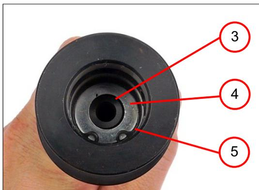
2. Placer le ressort hélicoïdal avec la douille (3).
