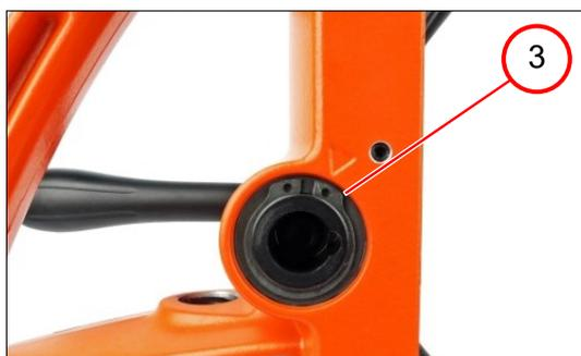
4. Placer le circlip (3).
