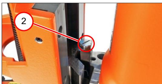
4. Serrer la vis (2) [2,7 Nm  $\pm 0,3$  Nm].
