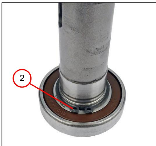
2. Placer le circlip (2).
