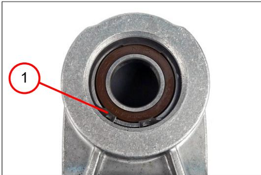
1. Den Sicherungsring (1) entfernen.
