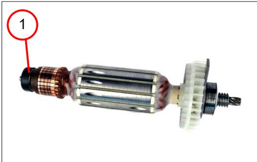
1. Die Lagerbuchse (1) entfernen.
