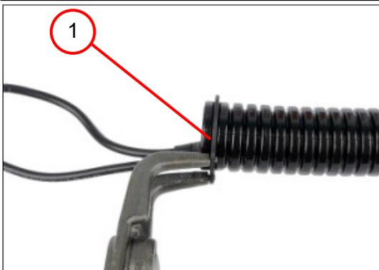
1. Den Sicherungsring (1) entfernen.
