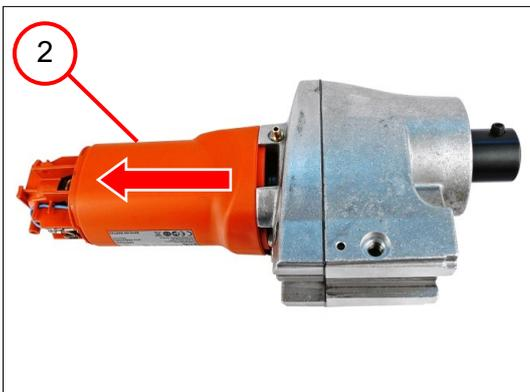
2. Das Motorgehäuse (2) entfernen.
