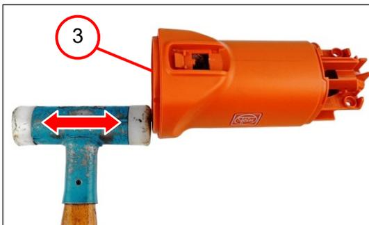
3. Den Stator (3) entfernen.
