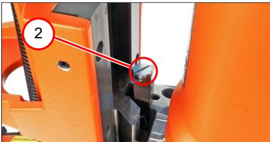
4. Die Flachkopfschraube (2) eindrehen [1,2 Nm  $\pm 0,15$  Nm].
