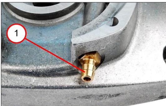
5. Die Schlauchtülle (1) eindrehen [1,8 Nm  $\pm 0,1$  Nm].
