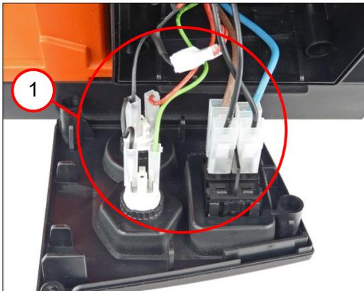
1. Alle Steckverbindungen (1) nach Anschlussplan anschließen.
