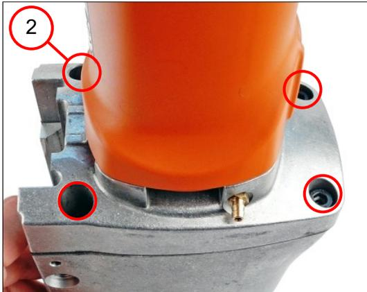
2. Die vier Schrauben (2) eindrehen [8,0 Nm  $\pm$ 0,3 Nm].
