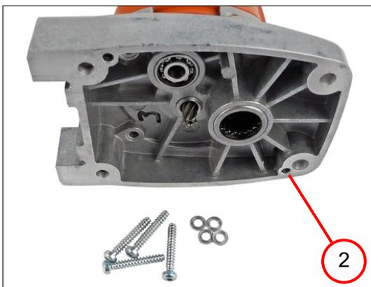
2. Das Zwischenlager (2) entfernen.
