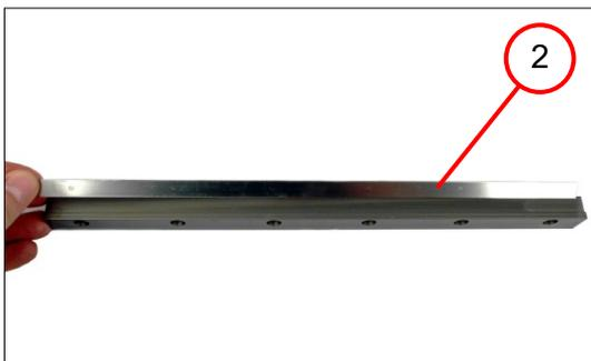
11. Das Druckstück (2) entfernen.
