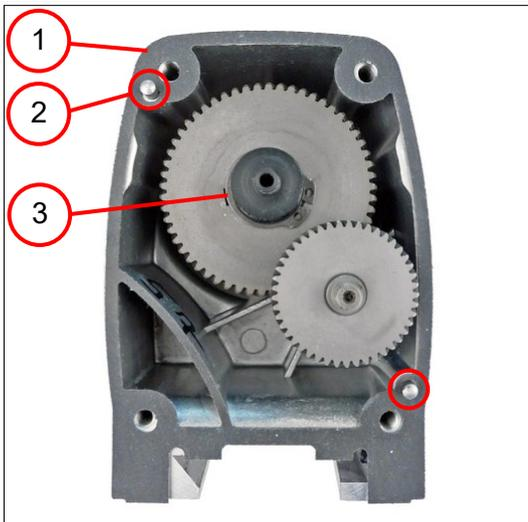
1. Die Dichtung (1) entfernen.
