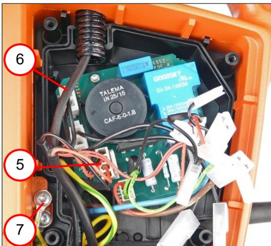
5. Das Kabel (5) nach Anschlussplan anschließen.
