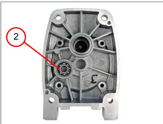
4. Das Rillenkugellager (2) entfernen.
