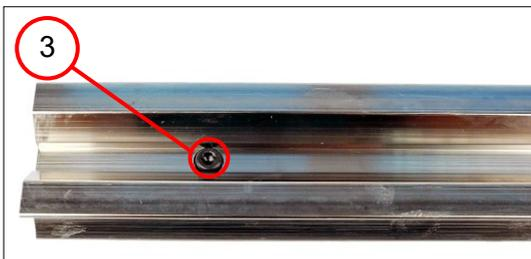
10. Die Schraube (3) eindrehen [3,0 Nm  $\pm 0,3$  Nm].
