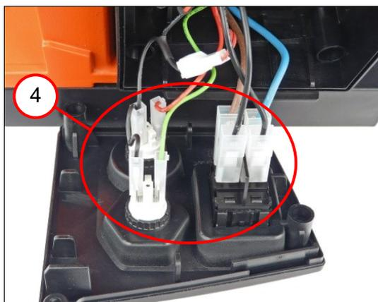
4. Alle Steckverbindungen (4) entfernen.
