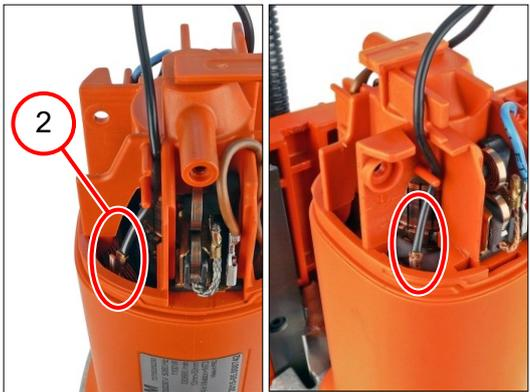
2. Die zwei Litzen (2) nach Anschlussplan anschließen.
