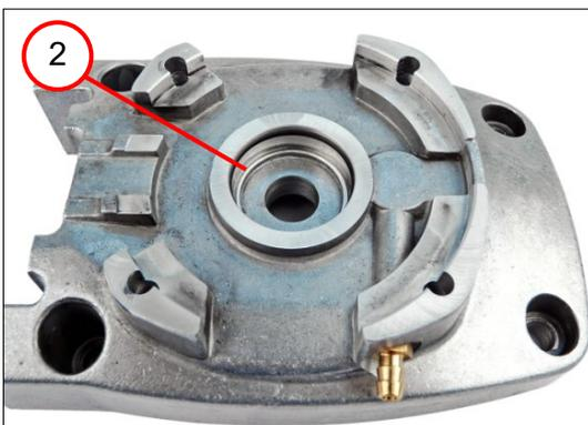
2. Den Dichtring (2) entfernen.
