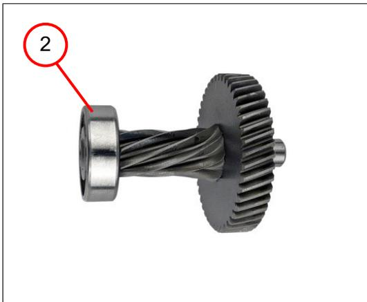
2. Das Rillenkugellager (2) abziehen.
