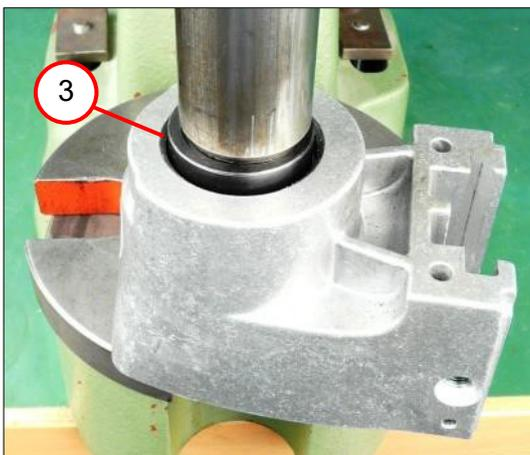
3. Das Rillenkugellager (3) einpressen.
