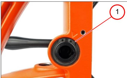
1. Den Sicherungsring (1) entfernen.
