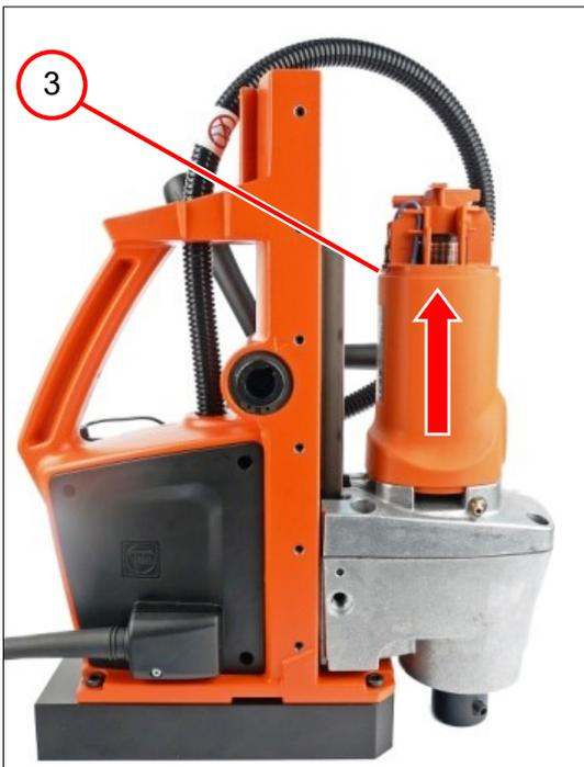
3. Den Bohrmotor (3) aus der Führung schieben.
