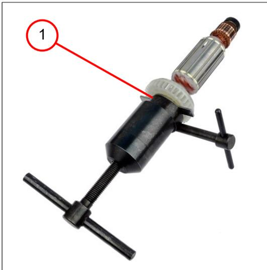
1. Das Rillenkugellager (1) entfernen.
