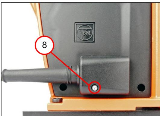
8. Die Schraube (8) eindrehen [0,9 Nm  $\pm$ 0,1 Nm].
