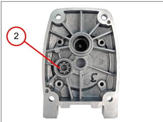
4. Das Rillenkugellager (2) einpressen.
