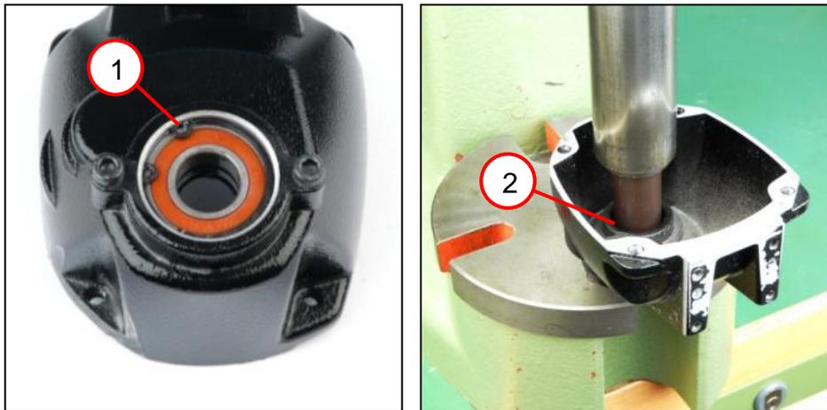
1. Den Sicherungsring (1) entfernen.
