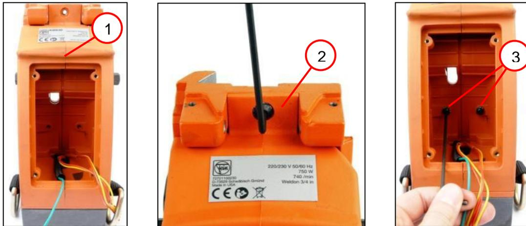
1. Das Gehäuse (1) aufsetzen und mit der Schraube (2), Zahnscheibe und Scheibe befestigen.
