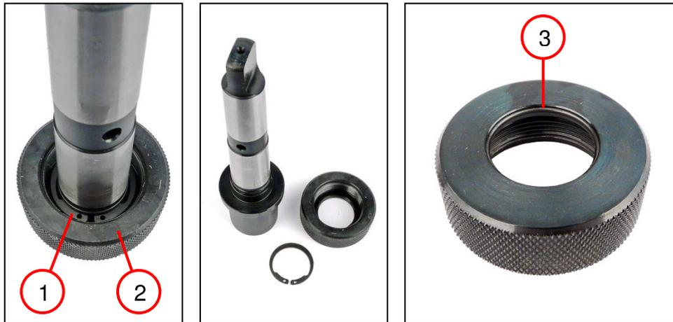
1. Den Sicherungsring (1) entfernen.
