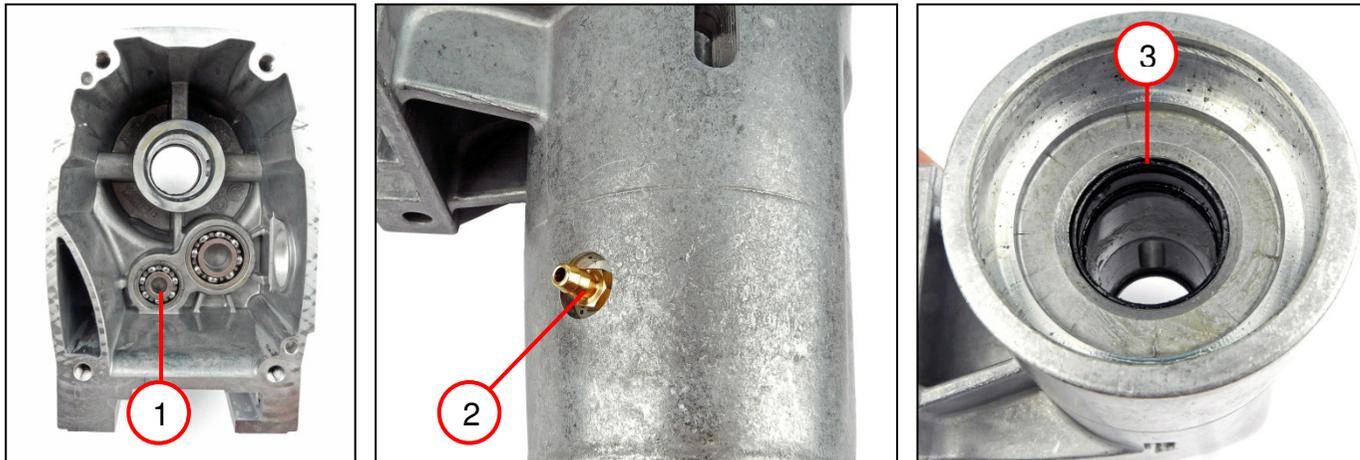
1. Die zwei Rillenkugellager (1) entfernen.
