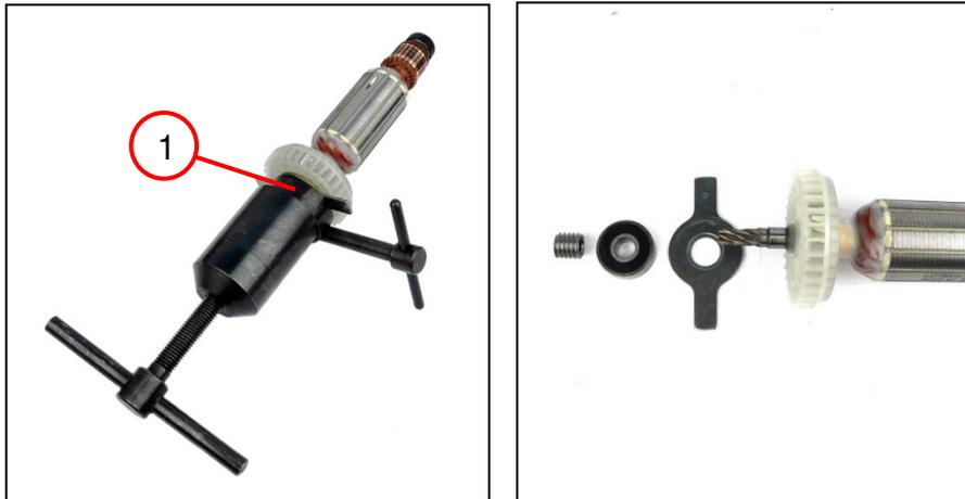
1. Das Rillenkugellager (1) entfernen.
