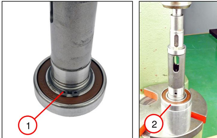
1. Den Sicherungsring entfernen.
