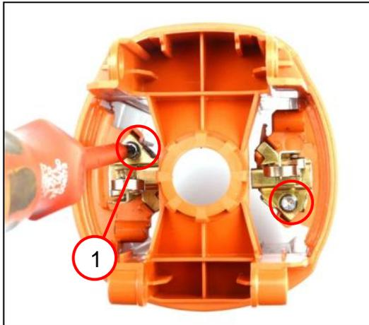
1. Die zwei Bürstenhalter (1) einsetzen und mit der jeweiligen Schraube befestigen.
