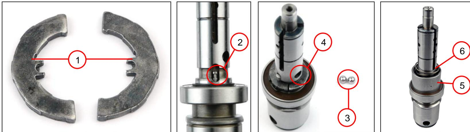
1. Mit den zwei Sicherungsscheiben (1) die zwei Bolzen (2) fixieren.
