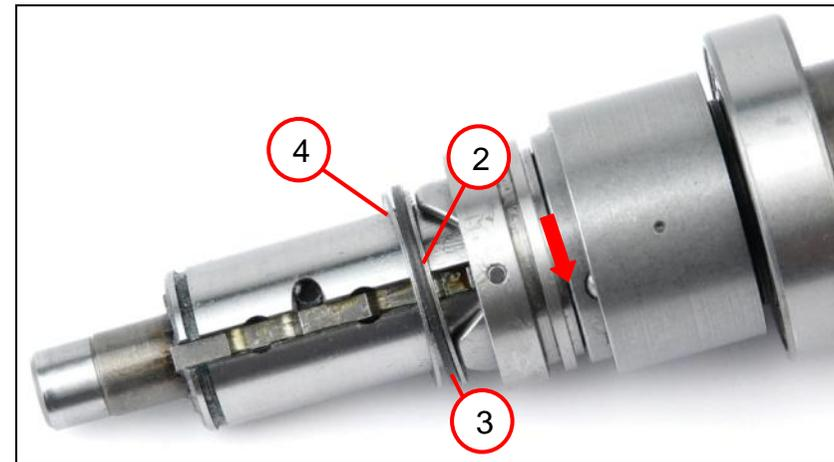
1. Die Scheibe (1) mit der Schalthülse in die Steuerhülse drehen und festhalten.
