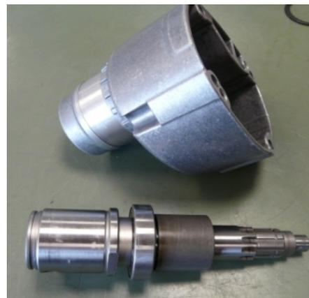
**Извлеките нажимную пружину и передаточный механизм.**
