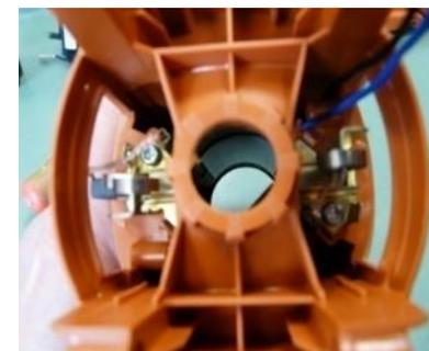
Вставьте полюсный пакет в корпус двигателя до упора.
