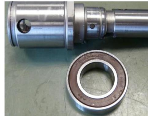
Извлеките две шпильки из вала дрели с передней стороны.
