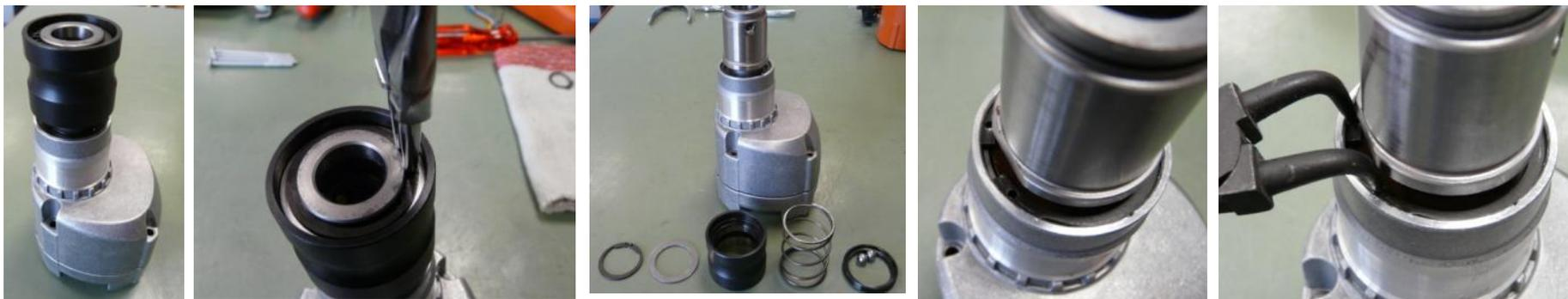
**Поставьте корпус редуктора на промежуточный подшипник.**
