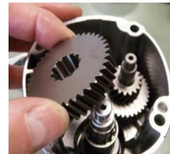
**Разъедините корпус редуктора и промежуточный подшипник.
