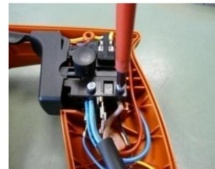
**Ослабьте винты и снимите верхнюю крышку ручки.
