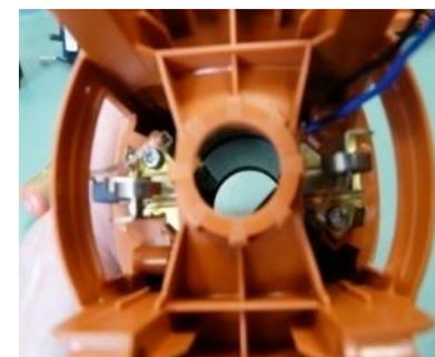
将定子装入电机机箱的止挡处 -
