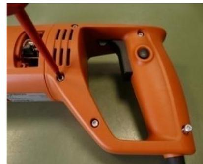
安装电源线和绞合线；绞合线是黑色的细电缆，具有断电重启锁定功能
