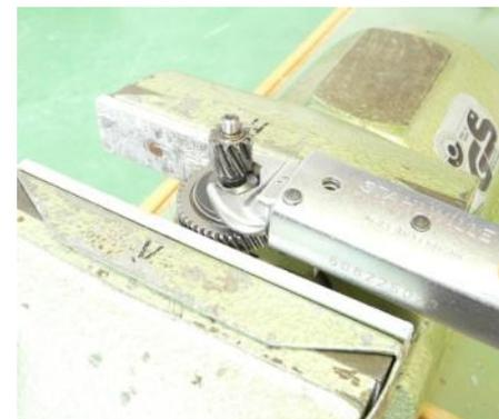
滑动离合器夹紧在带有铝制保护钳嘴的螺旋式虎钳内。
