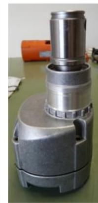
压入钻轴后，安装压紧弹簧
