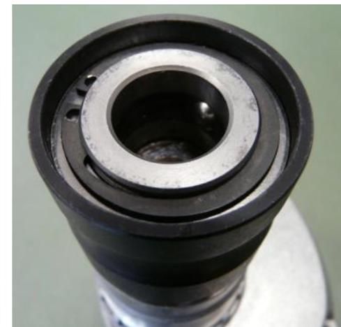
用卡环将钻轴固定在齿轮箱中
