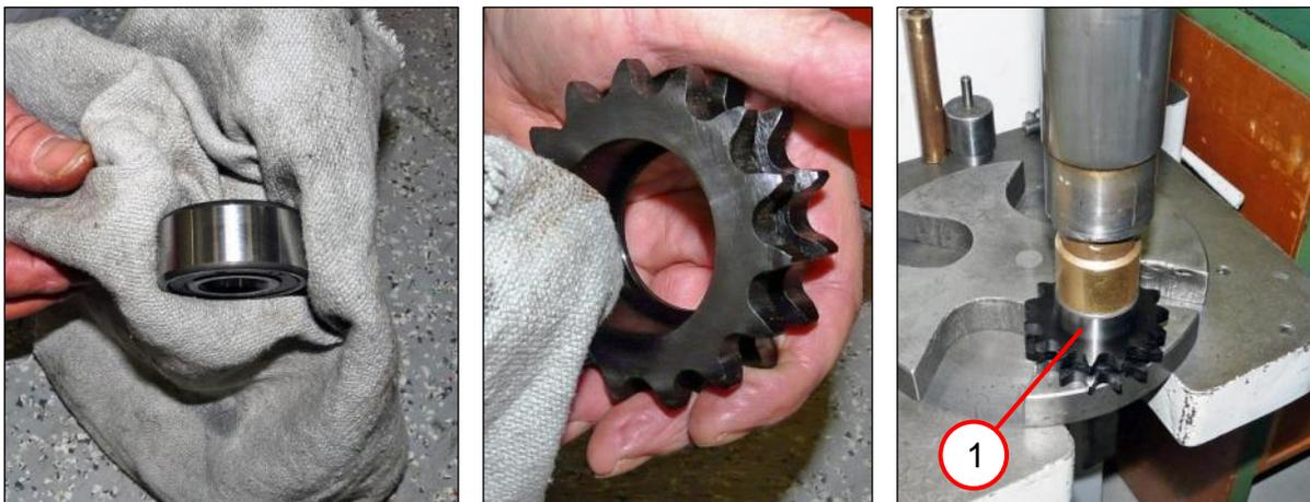
1. Dégraisser les surfaces de pression sur le roulement à billes et la roue dentée.
