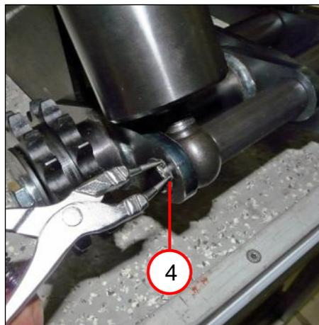
1. Monter le circlips (1).
