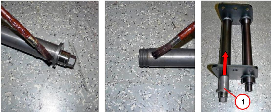
1. Die Welle an beiden Enden mit Getriebeöl bestreichen.
