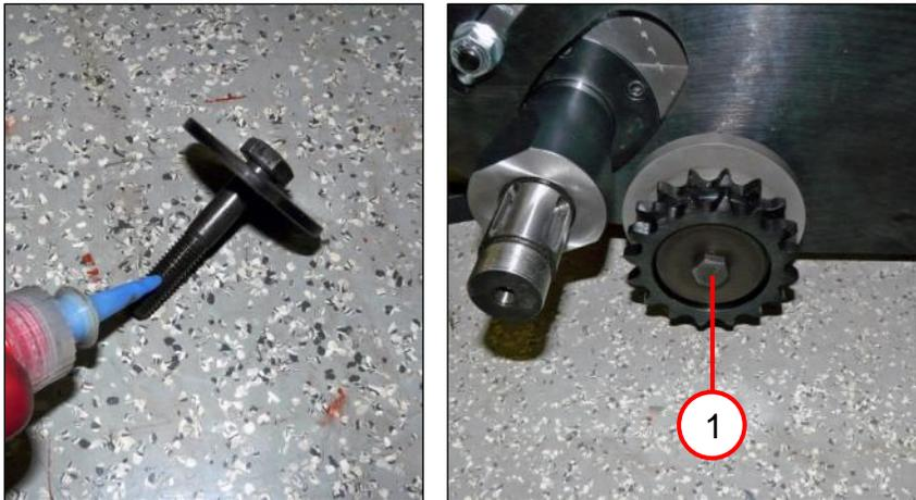
1. Die Schraube mit Loctite 242 benetzen.
