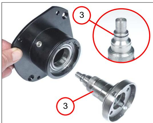
3. Placer la bague d'étanchéité (3).
