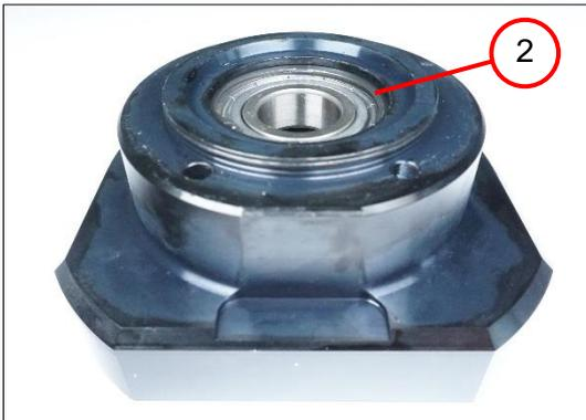
3. Placer le circlip (2).
