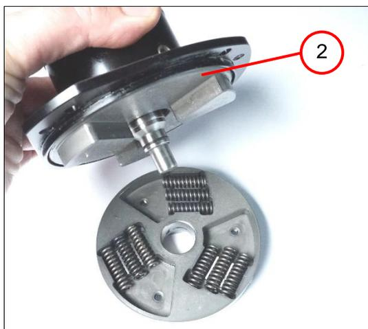
5. Placer le logement de roulement (2).
