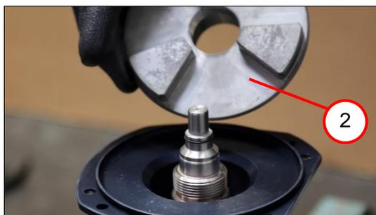
2. Placer le volant d'inertie (2).
