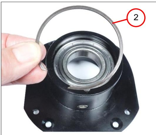
2. Placer le circlip (2).
