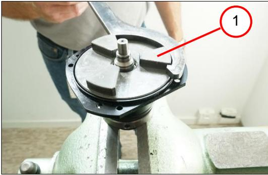
3. Fixer le logement de roulement au dispositif de montage.
