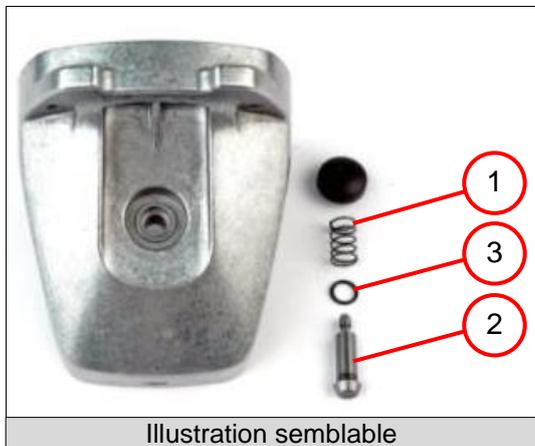
1. Mettre en place le ressort spiral (1) et le boulon (2) avec la bague d'étanchéité (3).
