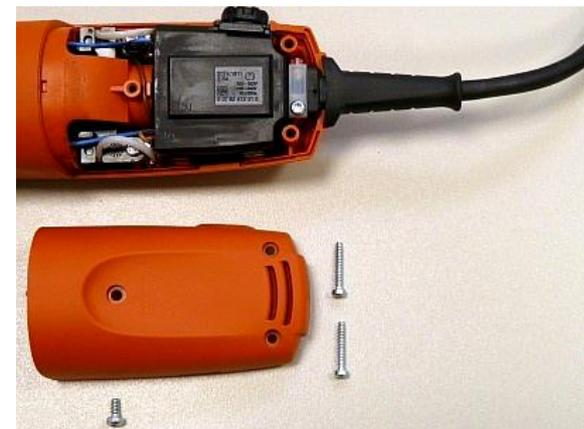
1. Conectar el cable de motor en el sistema electrónico.
