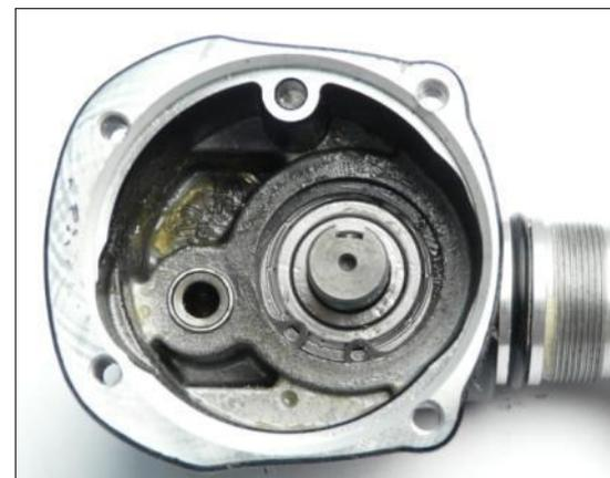
1. Insertar el arrastrador junto con el rodamiento de agujas en la mortajadora
