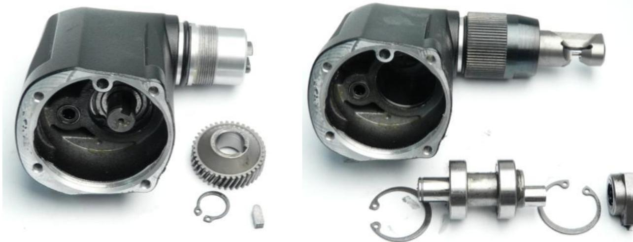
1. Снимите стопорное кольцо, зубчатое колесо и призматическую шпонку.
