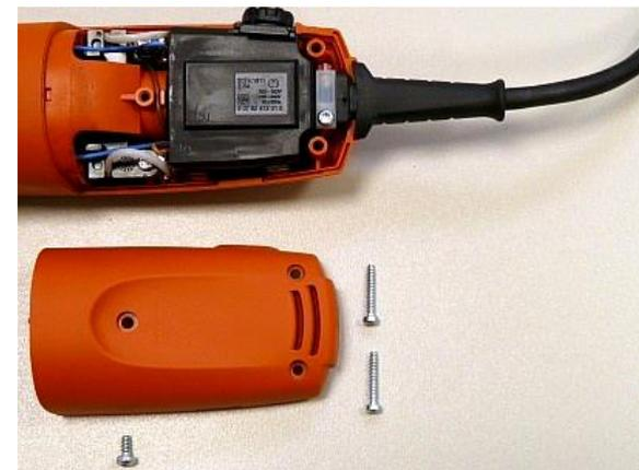
1. Подсоедините кабель двигателя к электронному блоку.
