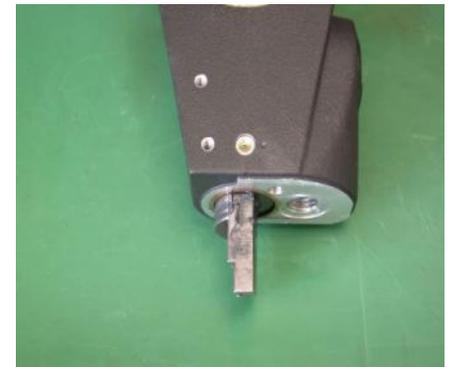
1. Zusges. Pleuel auf oberen Totpunkt einstellen und Gewindebolzen einschrauben - **Linksgewinde !!**
