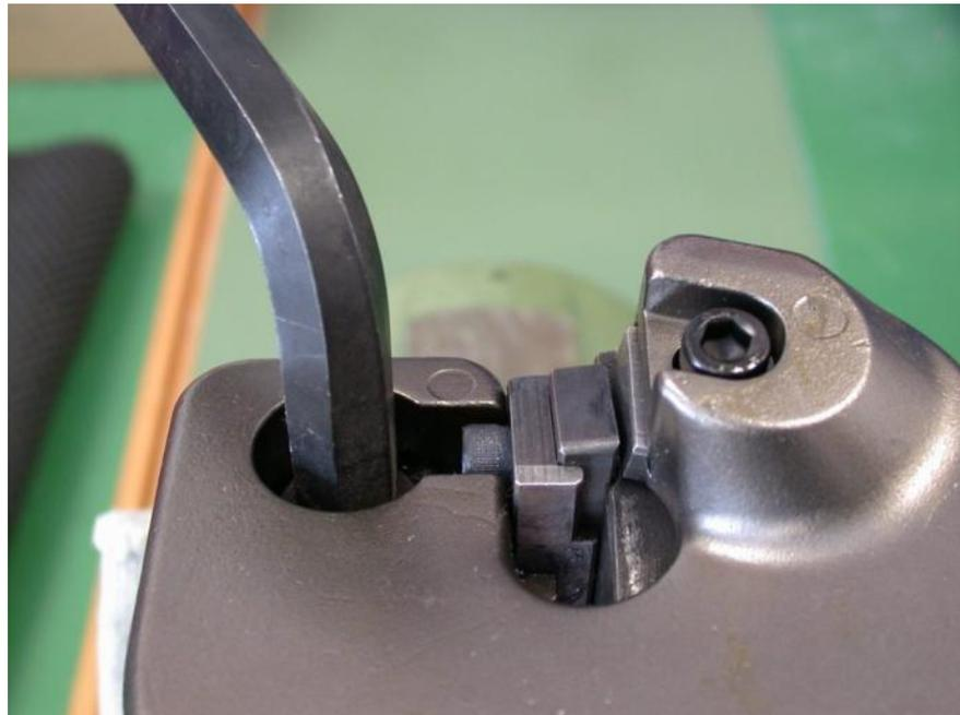
1. Schneidtable montieren ( 80 Nm )
