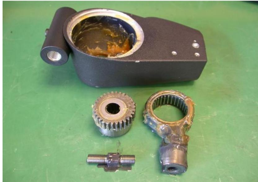
1. Gewindebolzen aus dem Pleuel heraus schrauben ( Linksgewinde )
